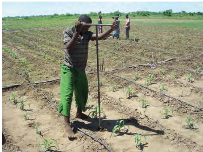
Photo 6.2 Les échantillons de sol doivent être prélevés avec une tarière à l'aide d'un bon schéma d'échantillonnage.
