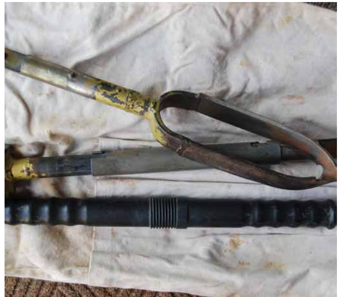
Photo 7.3 Une tarière Edelman est un outil essentiel pour l'échantillonnage des sols.
