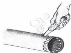
Perçage des trous par un clou chauffé
