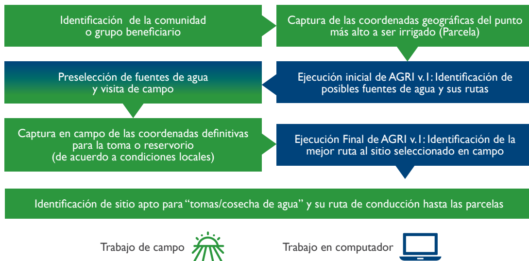
Figura 1-1. Flujograma para identificación de fuentes de agua con AGRI v.1.
