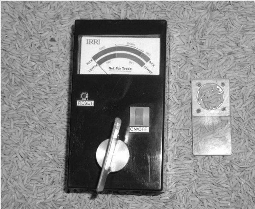
Figure 25 : Humidimètre permettant de mesurer la teneur en humidité des graines. Son mode d'emploi est décrit ci-dessous.
