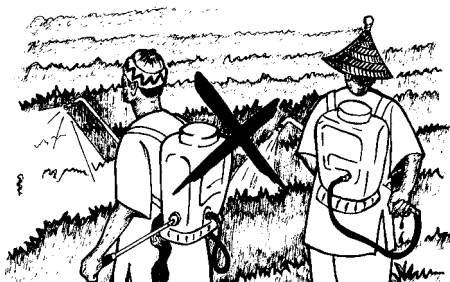
Figura 29: Nunca trabalhe com equipamento com fugas; isso é particularmente perigoso quando a pele não se encontra protegida
