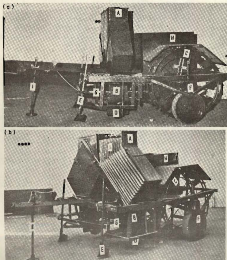
Figura 2 (a). Vista del lado izquierdo de la sembradora de yuca: A - tolva; B - cilindro dosificador; C - rueda de transmisión; D - tapasurcos/caballador; E - abresurcos; F - rueda de transporte; G - puerta de vaivén; H - receptáculo para las estacas de yuca; I - soporte para la sembradora. (b). Vista de la sembradora de yuca con la puerta de una de las tolvas abierta para poder observar las celdas - M; [ las letras corresponden a las mismas partes identificadas en la Figura 2 (a) ] .
