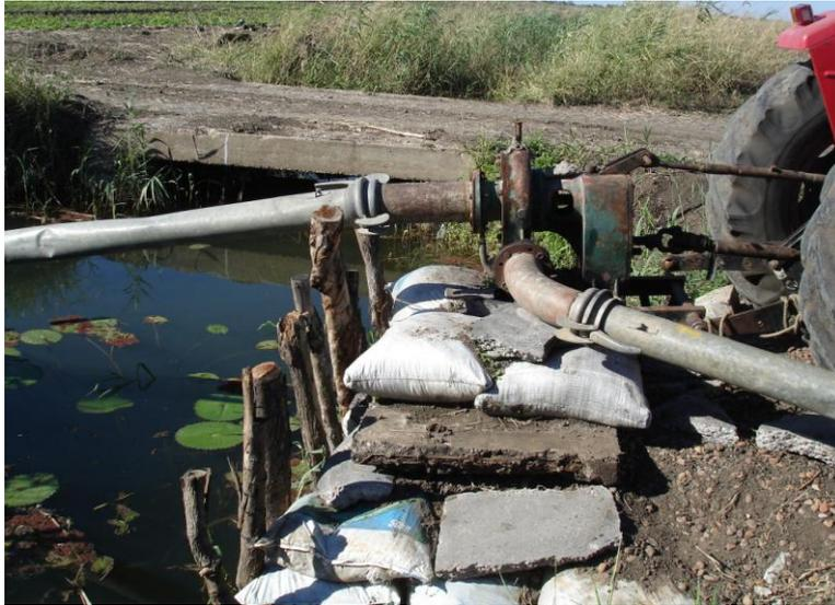
**Figura 6:** Captação da água numa vala de drenagem (distribuidor D9)
