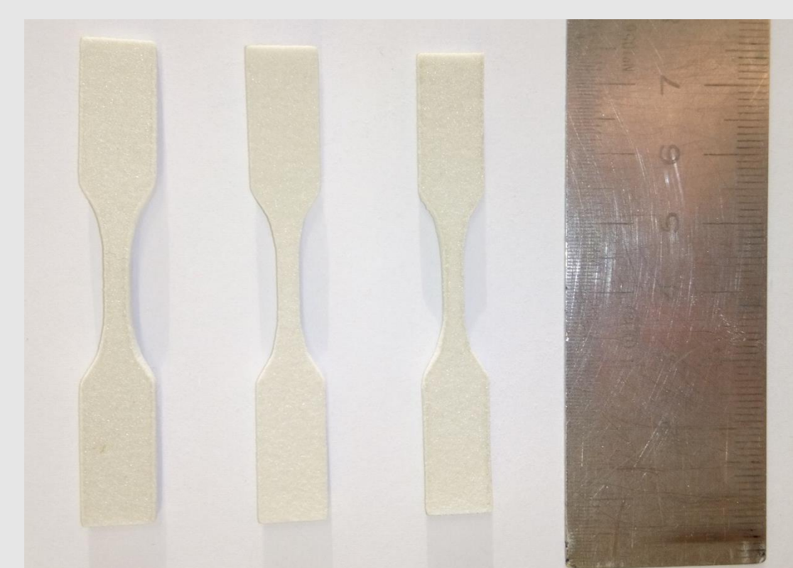
Actual sintered parts ready for tensile testing
