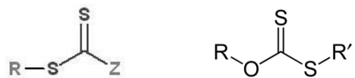
Figuur 3 : (links) Algemene structuur van een RAFT reagens; (rechts) Algemene structuur van een xanthaat
