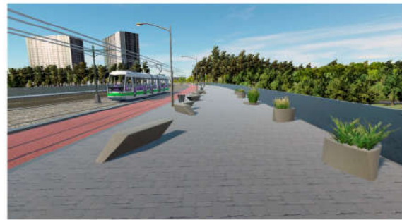
V2- Modern S2 - 1.2 m barrier: LAeq reduction 7.9 dB
