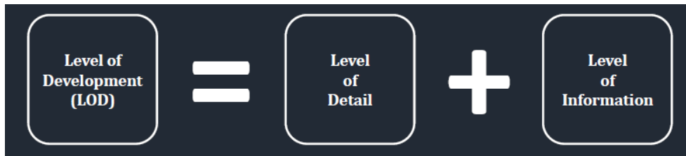
Figura 2.8: Constituição do Level of Development (CT197 BIM, 2016)
