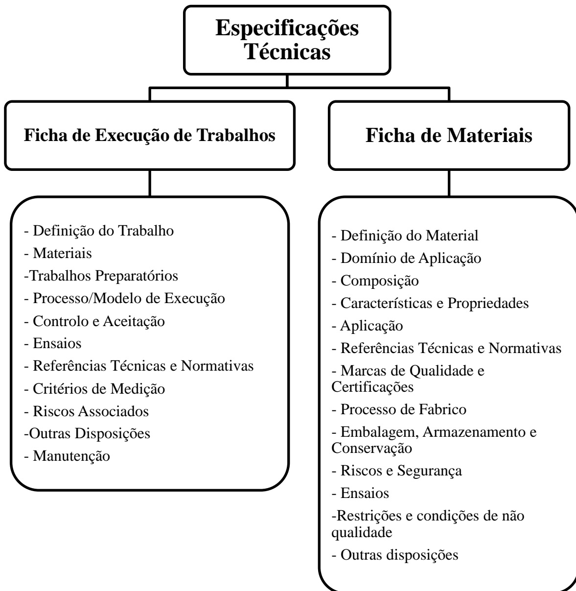
Figura 3.7: Estrutura padrão de FET e FMAT existentes no ProNIC
