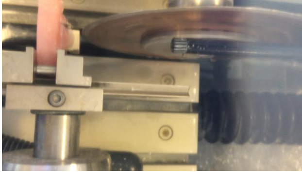
Figura 5. Bloque de zircona siendo cortado para obtener las láminas de la muestra.
