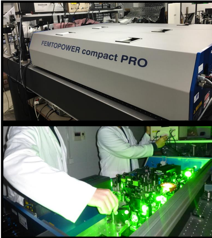
Figura 8. Láser de femtosegundos utilizado para preparar las superficies de zircona.
