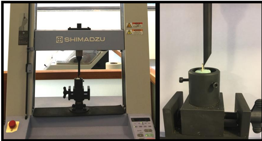
Figura 15. Máquina de pruebas universal utilizada para las pruebas de fuerza de adhesión y muestra siendo sometida a la prueba.
