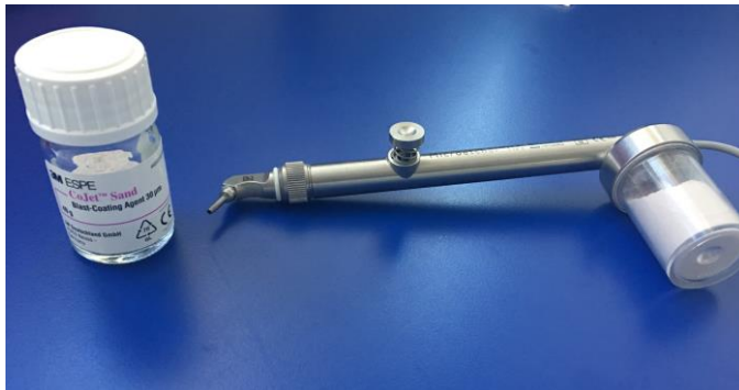
Figura 19. Material utilizado para la técnica de silicatización (Partículas de alúmina recubiertas con sílice Cojet™ y arenadora).
