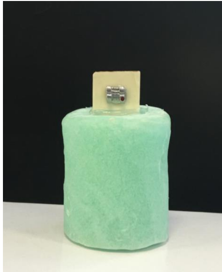
Figura 14. Muestra fijada con cola termofusible a un cilindro de acrílico.
