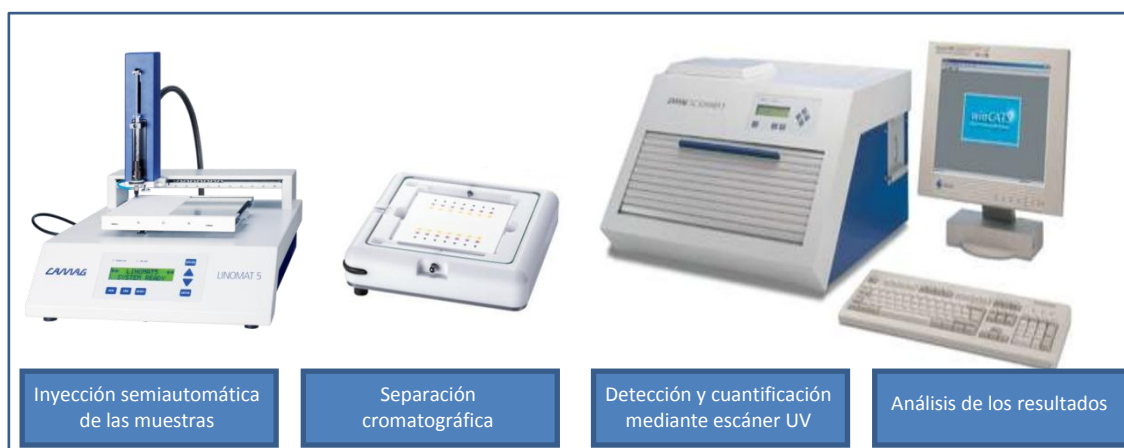
Figura 24: Esquema del procesamiento de muestras mediante HPTLC.
