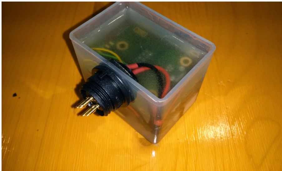
Figure 2.15: Wasserdicht vergossenes GPS-Modul.
