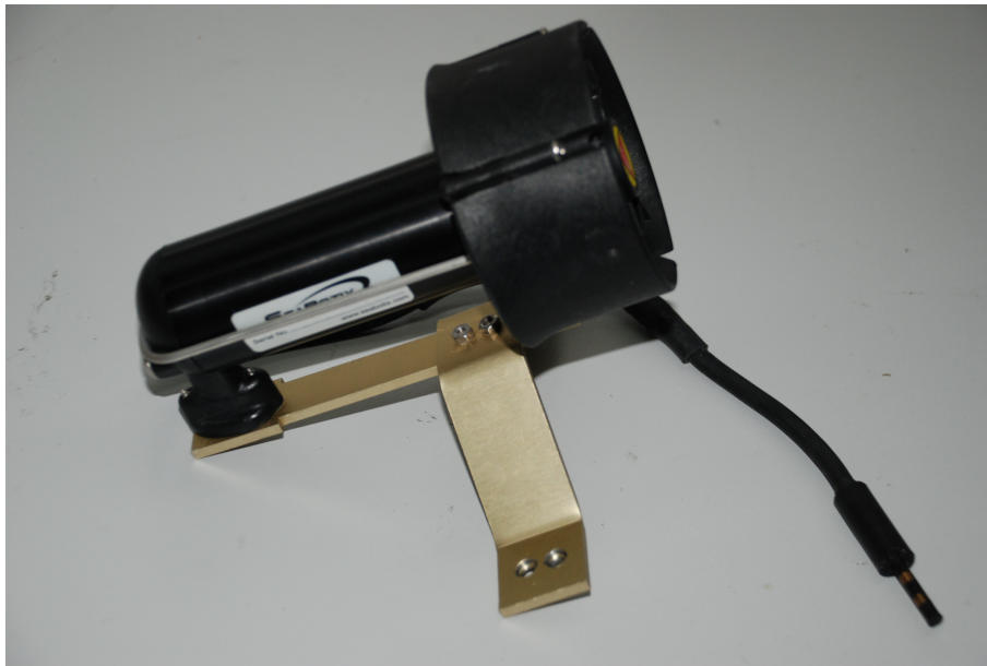
Figure 2.13: Antriebe des Systems Avalon vom Typ SeaBotix BT-150
