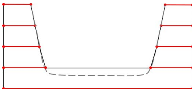
Abbildung 4.12: Interpolierte Werkstückoberfläche (schwarz) mit mehreren Anfangs- und Endpunkten in einer Raumrichtung.
