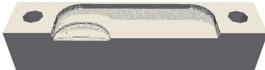
(b) Extrahiertes Werkstückgebiet \bar{\Omega}_h(t) mittels Threshold -Filter.
