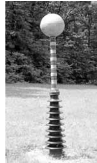
1. ábra A nagycenki Széchenyi István Geofizikai Observatóriumban (SZIGO) Schumann-rezonancia antennája.
