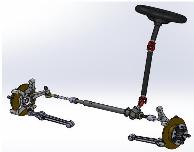
Figura 28. Sistema de dirección adaptado
