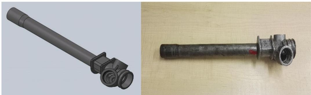
Figura 21. Rotula de extremo de la barra de acoplamiento
