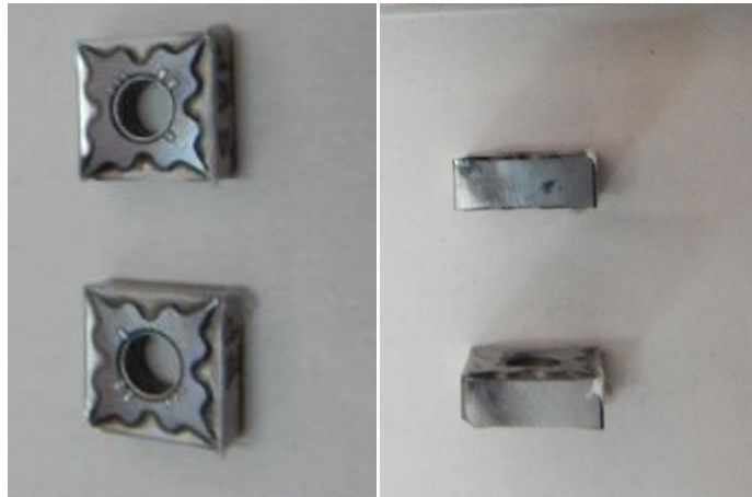
Figura 3. Inserto HM utilizado en los ensayos, fuente: Carlos A. Montilla [2]
