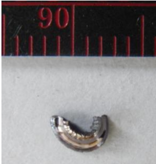
Figura 13. Virutas obtenidas al torneado con herramienta HM. Fuente: [1] y [2]
