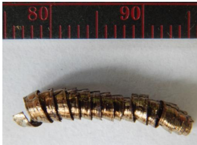
Figura 12. Virutas obtenidas al torneado con herramienta HSS. Fuente: [1] y [2]
