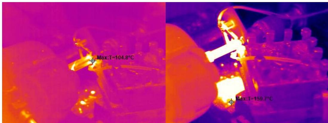
Figura 26. Imagen termográfica de proceso de torneado. Fuente: [1] y [2].
