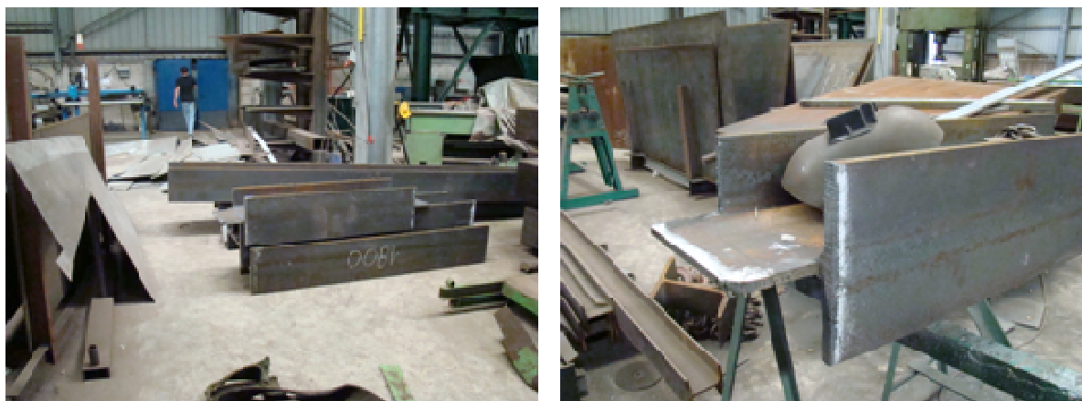
Figura 3-26 – Corte dos perfis principais
