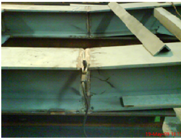
Figura 3-31 – Pormenor das soldaduras dos perfis
