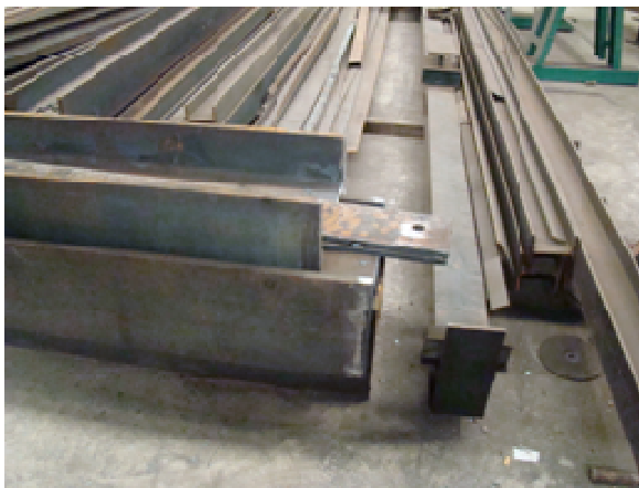
Figura 3-28 – Corte dos perfis principais
