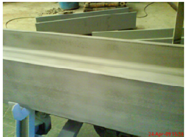
Figura 3-29 - Pormenor dos perfis após decapagem
