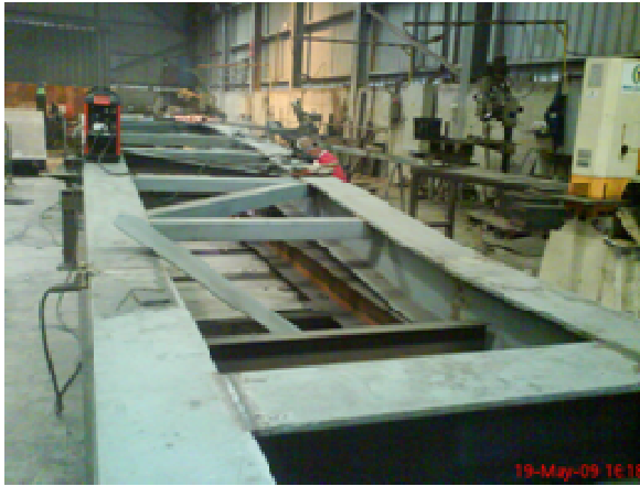
Figura 3-30 – Soldagem da estrutura metálica principal e dos electródes utilizados
