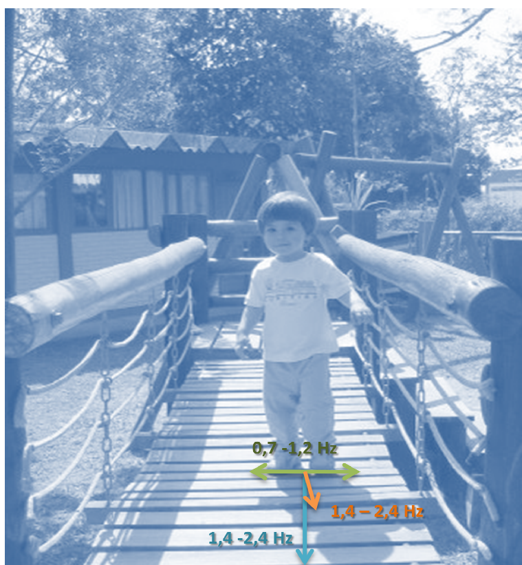
Figura 2-1 – Componentes da força induzida por um peão e respectivas frequências
