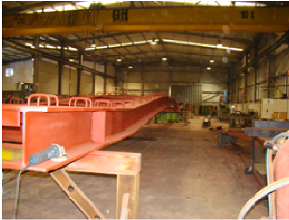
Figura 3-35 - Estrutura metálica do tabuleiro
