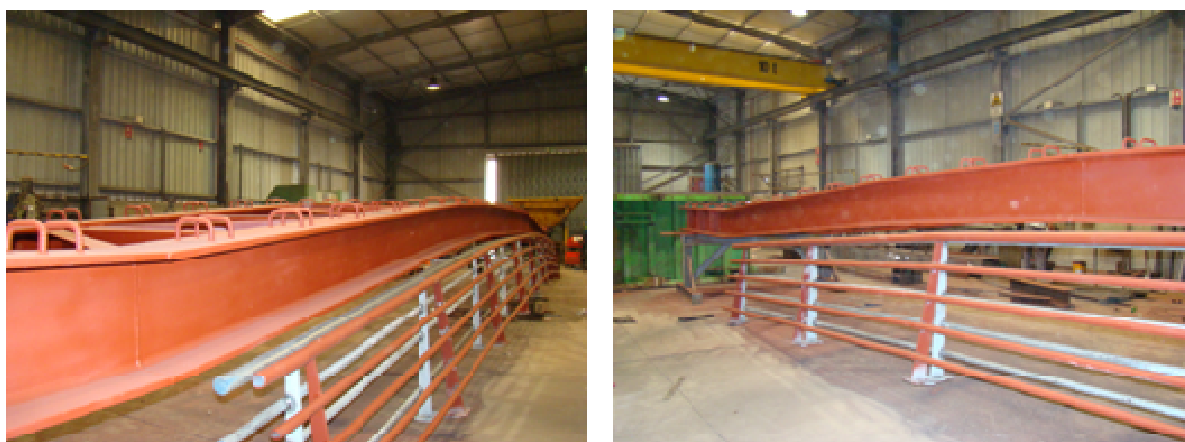
Figura 3-34 – Estrutura metálica do tabuleiro e respectivas guardas
