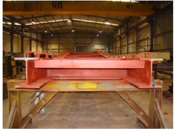
Figura 3-35 - Estrutura metálica do tabuleiro
