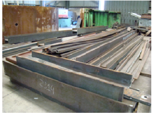
Figura 3-27 – Corte dos perfis principais
