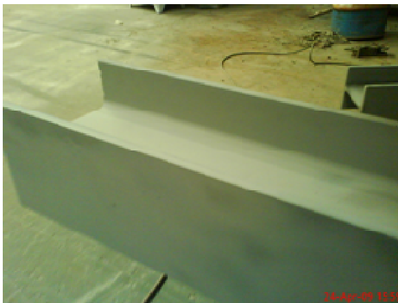
Figura 3-29 - Pormenor dos perfis após decapagem
