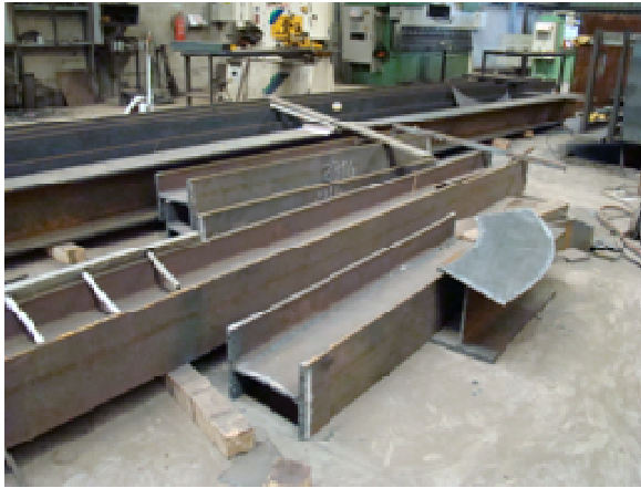
Figura 3-27 – Corte dos perfis principais
