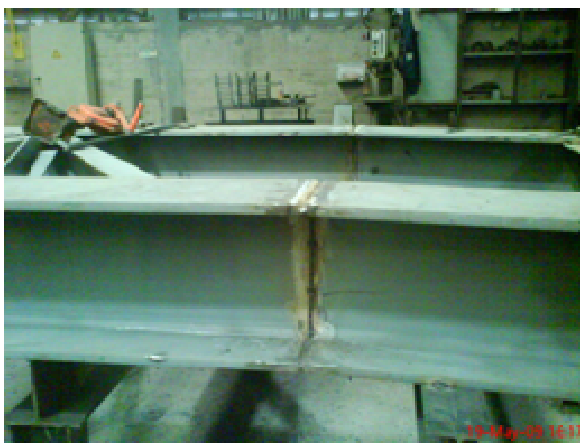
Figura 3-32 – Soldaduras nos perfis
