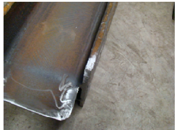
Figura 3-28 – Corte dos perfis principais
