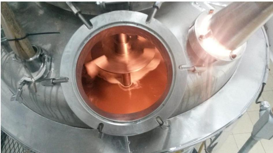
**Figura 21:** Vista externa del fermentador de 1000L utilizado para el escalado de la producción de EGasa1 (A). Vista interna del fermentador, donde se puede apreciar uno de los mezcladores y el cultivo post- fermentación (B).
