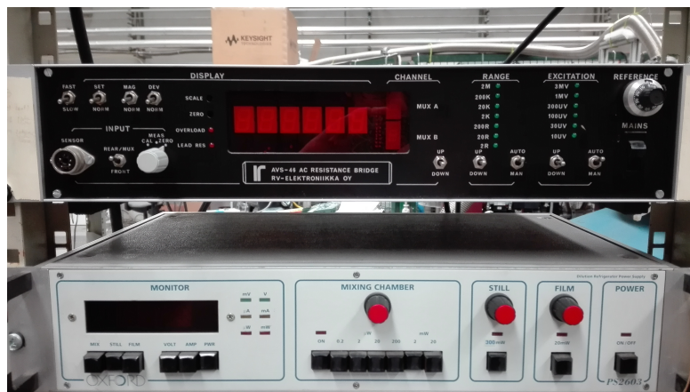
Figura 2.1: Front Panel del ponte resistivo AVS-46.
