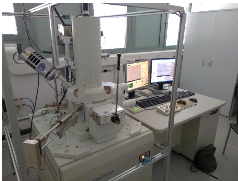
Figura 24. SEM "JEOL JSM-7001F" realitzant l'EBSD.
