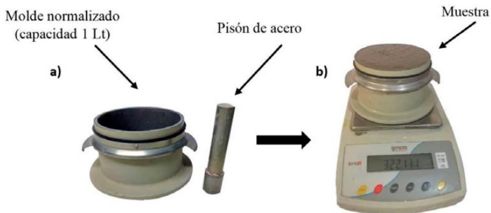
Figura 3. a) Molde normalizado y pisón, b) Pesado en báscula
