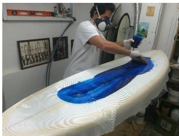
Ilustración 14 . Fuente: The Good Karma Project. Aplicación del Wet Layup
