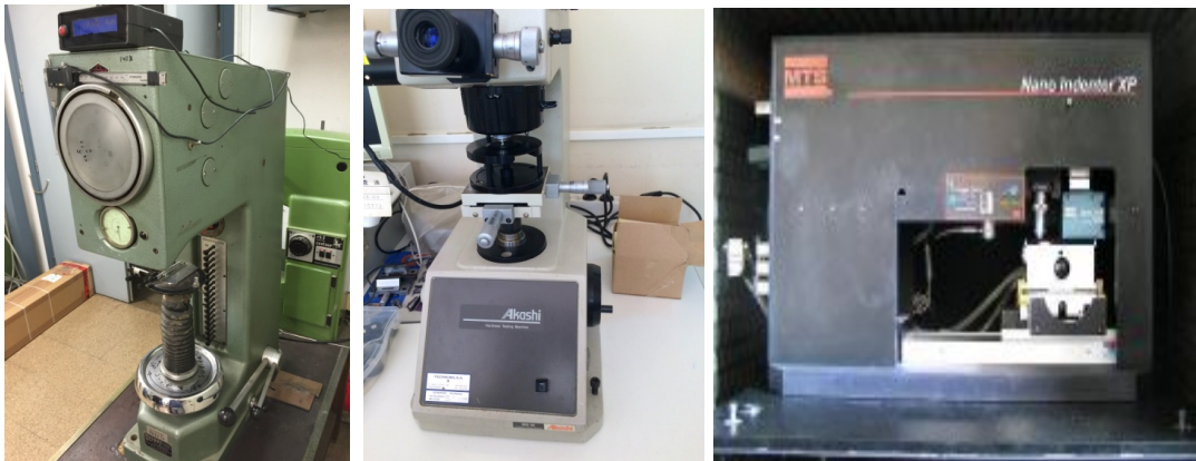
Figura 3.35. Duròmetres. D'esquerra a dreta, Frank (Macro), Akashi MVK-H0 (Micro), Nano Indenter XP (Nano).
