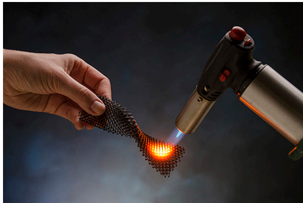
Figura 1.25. Material ceràmic imprès per 3D de HRL Laboratories, LLC sota altes temperatures [68]
