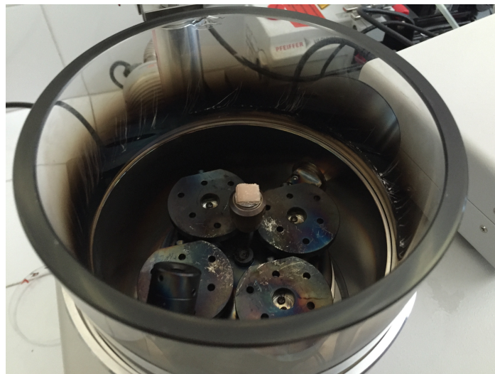
Figura 3.30. Mostra recoberta de Platí i Pal·ladi a l'interior de la cambra de buit
