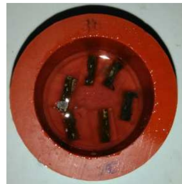
Figura 8. Tac de resina amb 6 mostres de noteixit amb ciment.
