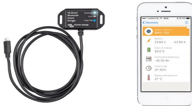
Figura 21. VE Direct Bluetooth Smart dongle i aplicació de control a temps real al smartphone
