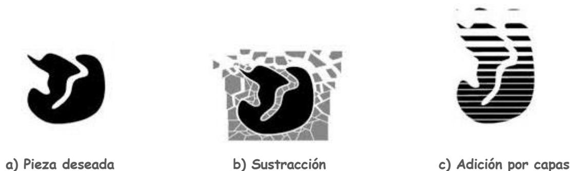
**Fig. 3.1. Principio de fabricación sustractiva comparado con el de fabricación aditiva [39].**
