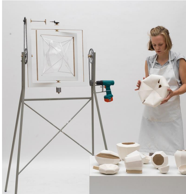
Muestra de piezas fabricadas con una máquina de rotomoldeo casera, en este caso, de metal.
