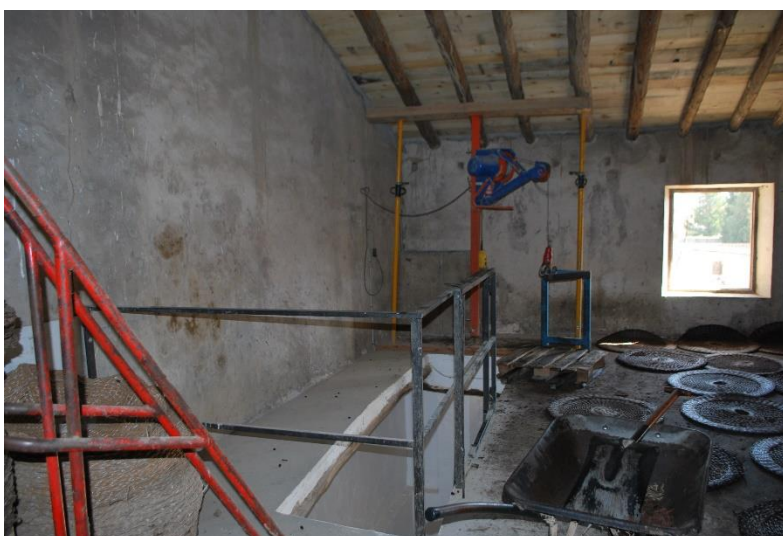
Ilustración 2: Polipasto y hueco que permite subir las cajas para su posterior vaciado en la tolva del molino nº1
