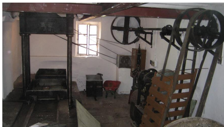
Il·lustració 2: en la parte izquierda de la imagen se observa la prensa y en la parte derecha el mecanismo para el funcionamiento de los empiedros.
