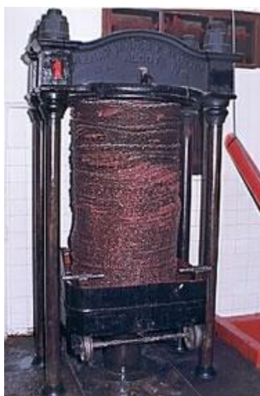
Ilustración 1: Prensa cargada con capachos de esparto y, entre ellos, la pasta molida
