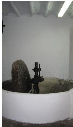
Il·lustració 1: la fotografia de la izquierda corresponde al empiedro de 1,3 m y, la de la derecha, al de 1,5 m de diámetro.
