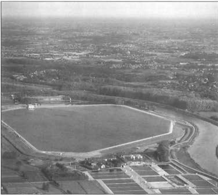
(foto nr2) Oppervlaktewater als grondwaterbron : het Spaarbekken Eekhoven en bijbehorende productie-eenheid
