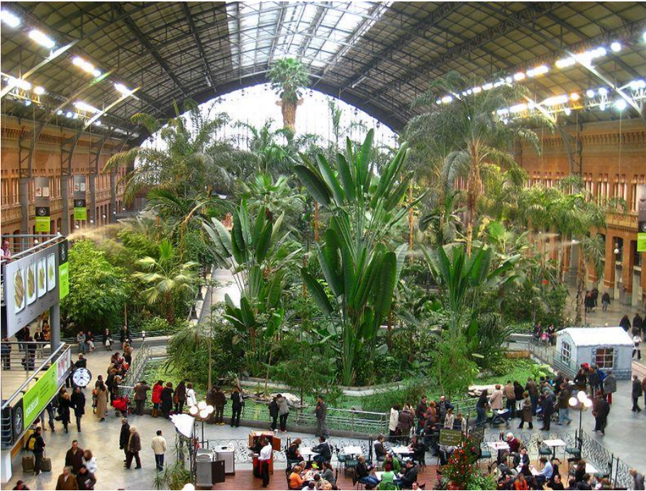
Kuva 110. Madridin Atochan rautatieaseman asemahalli toimii teräs-lasi-rakenteensa ansiosta myös kasvihuoneena. Asemahalli on 1800-luvun jälkipuoliskolle tyypillisesti katedraalimainen. (Wikimedia Commons).
