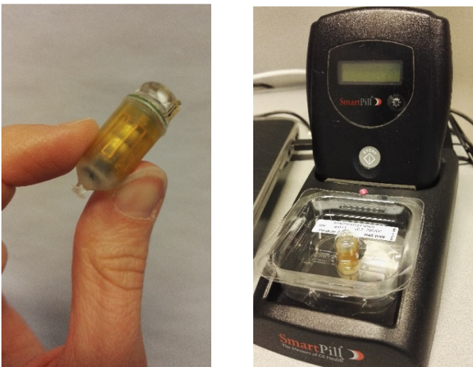
Kuva 2. Vasemmalla: SmartPill-kapseli. Oikealla: SmartPill-kapseli ja -vastaanotin telakassa.
