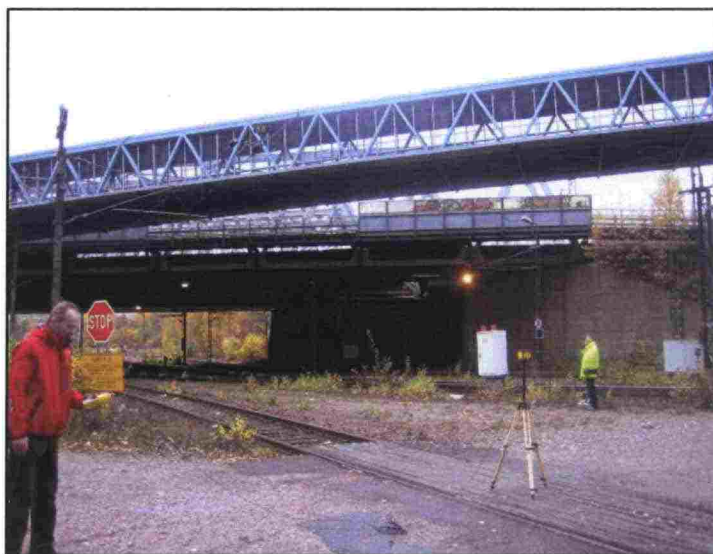
Kuva 21. Sähkökentän mittaus radan ylityskohdalla.
