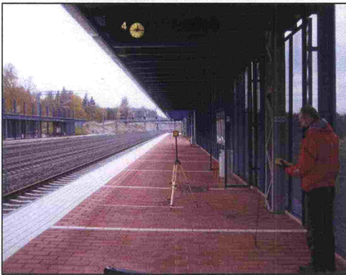
Kuva 15. Sähkökentän mittaus suojakatoksen alla Haarajoella.
