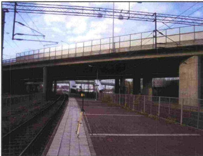
Kuva 19. Sähkökentän mittaus laiturilla 3 Käpylän asemalla.
