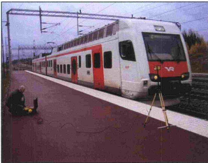
Kuva 22. Sähkökentän mittaus junan tullessa asemalle.
