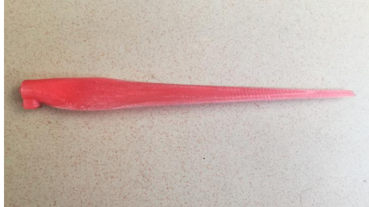
Ilustración 4.1.1.3 -Pala realizada con impresión 3D
