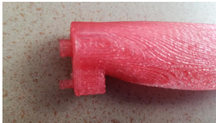
Ilustración 4.1.1.4.-Diseño del enganche al sistema de cambio de paso de pala
