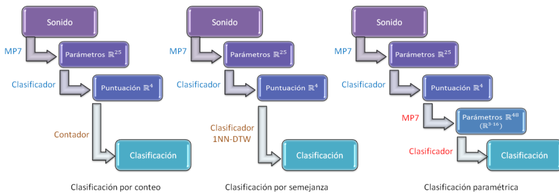
Figura 6-18 Resumen procedimiento de clasificación de series derivadas por conteo, semejanza y paramétrica
