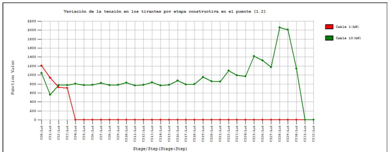
Fig. 3.1.2.2. Variación de la tensión en los tirantes en el puente 2LV-Arpa
