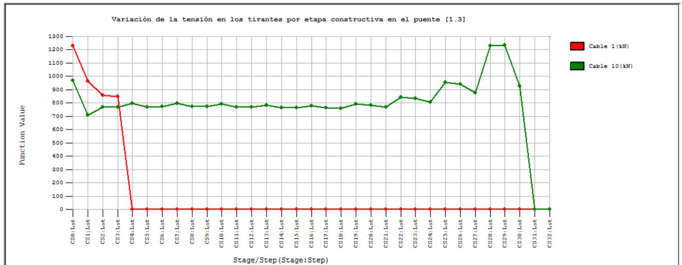
Fig. 3.1.2.3. Variación de la tensión en los tirantes en el puente 2LV-Intermedia
