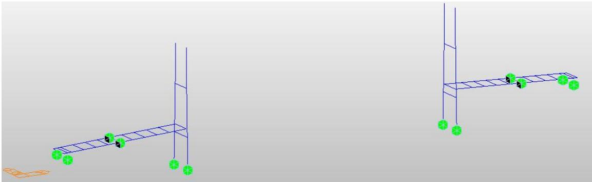
*Fig. 2.4.41. Apoyos auxiliares en el proceso constructivo*
