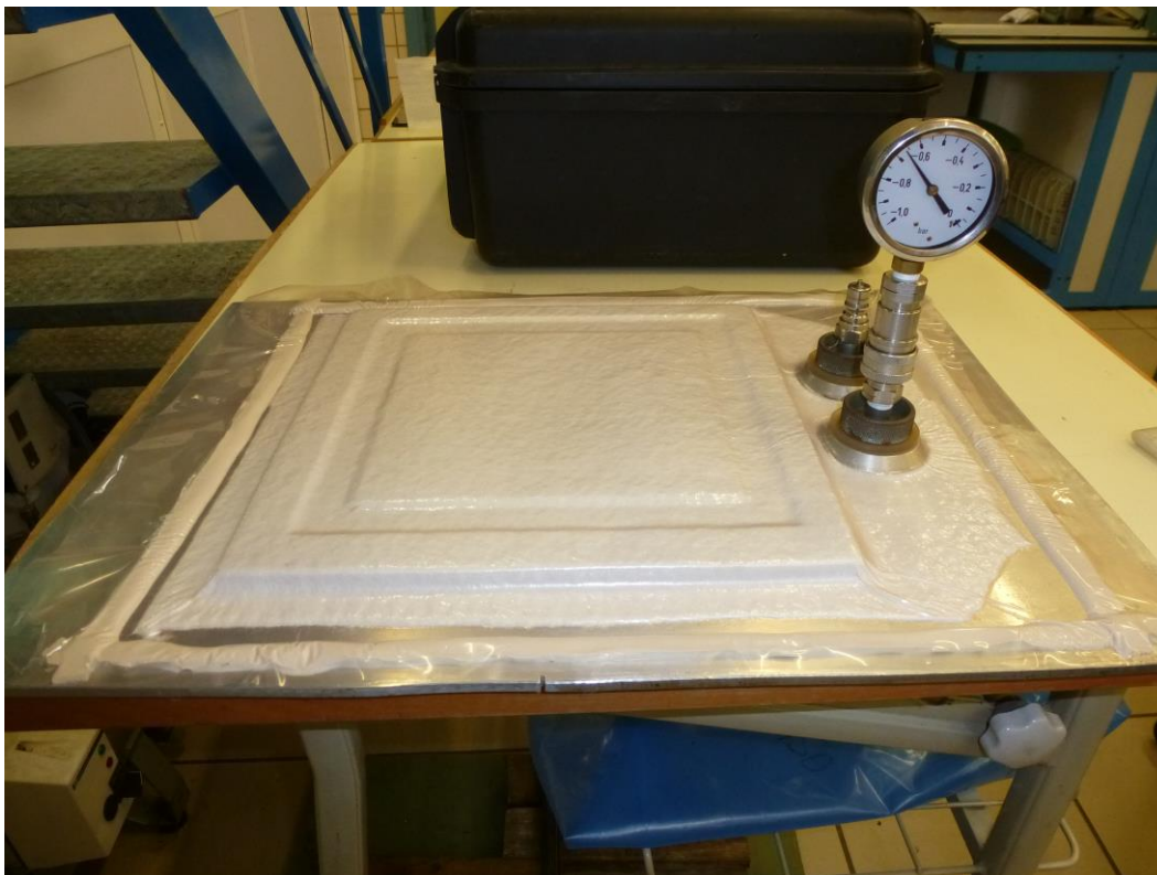
Figura 4.18: Comprobación del vacío mediante medida estable del vacuómetro.
