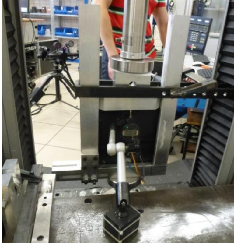
Figura 7.8: Reloj comparador instalado en la parte posterior.
