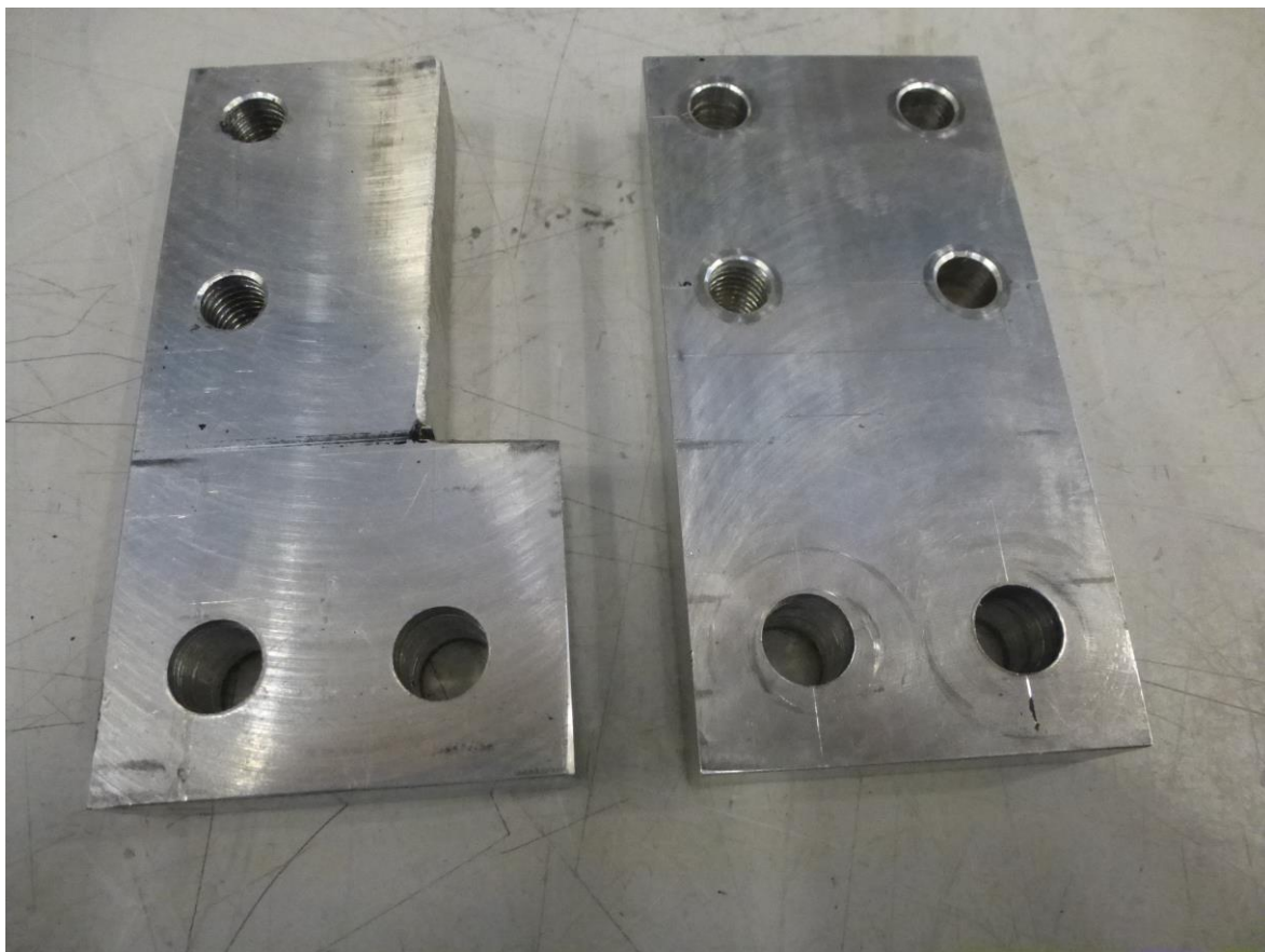
Figura 5.9: Pieza auxiliar delantera de agujeros roscados cortada y pieza posterior.
