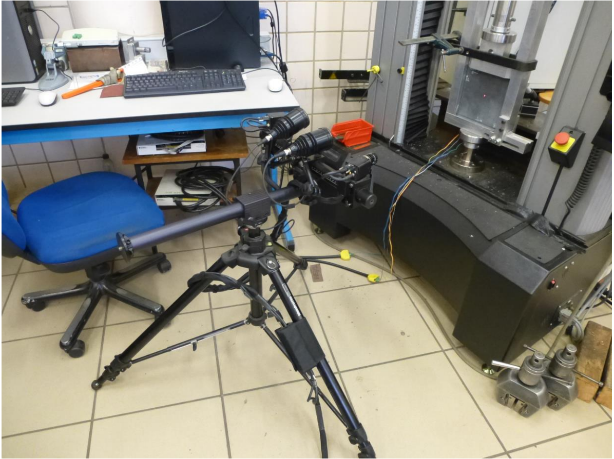
Figura 6.4: Sistema ARAMIS antes de uno de los ensayos.
