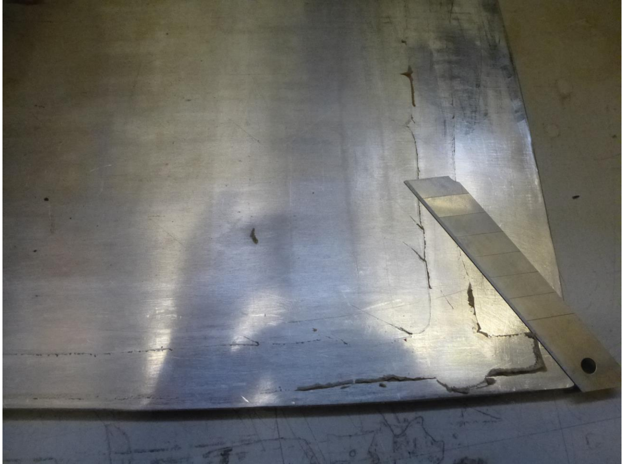
Figura 4.8: Limpieza de las planchas de aluminio.
