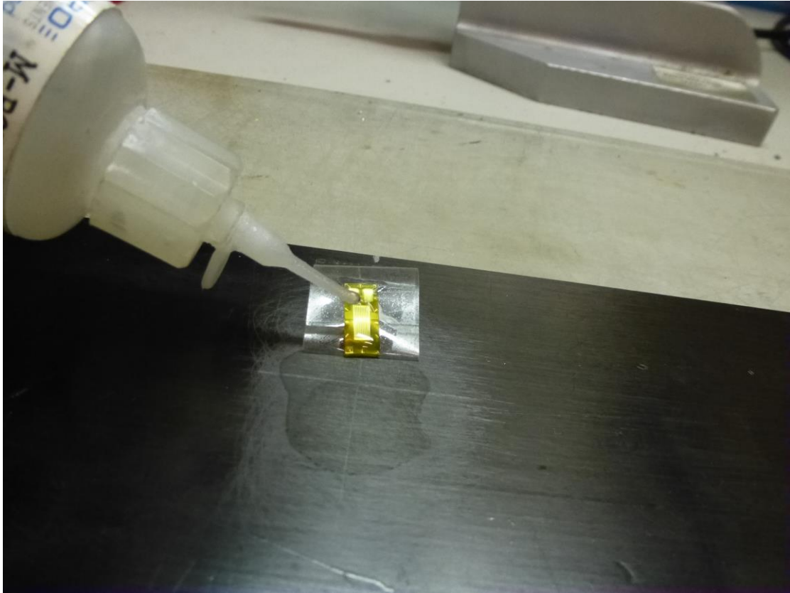
Figura 6.14: Aplicación del adhesivo sobre la superficie de la galga.
