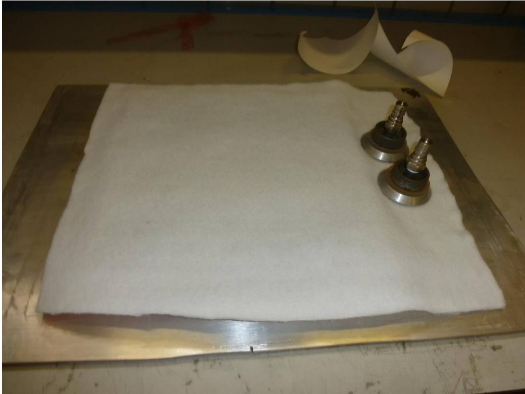
Figura 4.13: Colocación del Airwave y comprobación del lugar de las válvulas de vacío.
