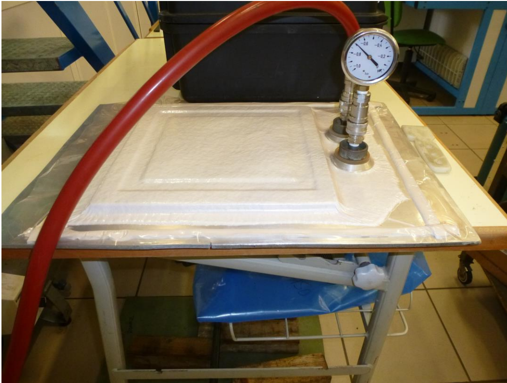
Figura 4.17: Aplicación de vacío a la bolsa y medida del vacuómetro.
