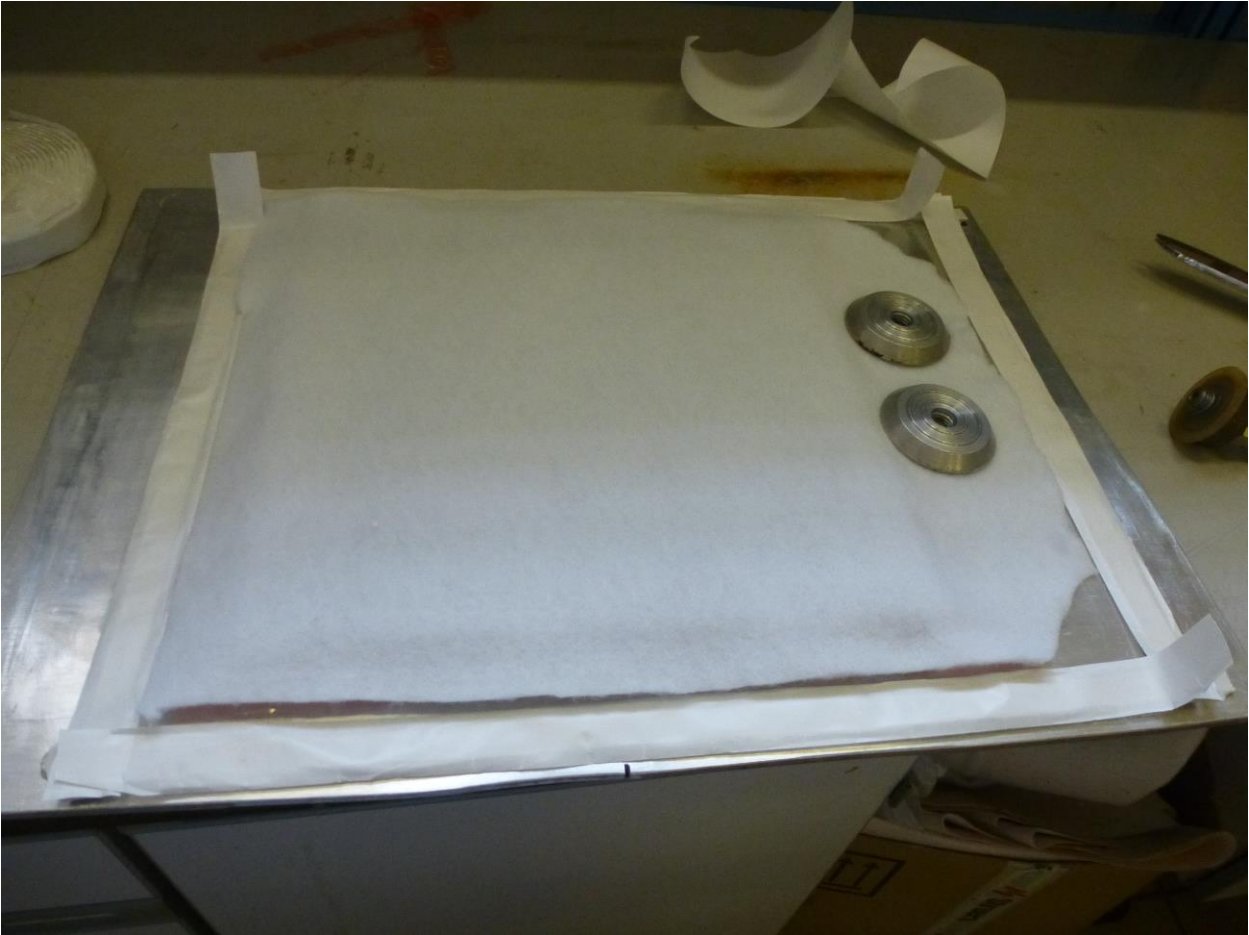
Figura 4.14: Bandas de cromato recién colocadas y las bases de las válvulas de vacío.
