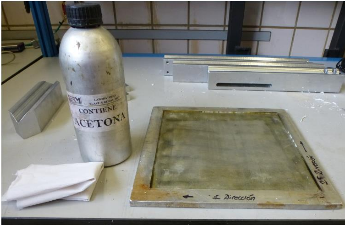
Figura 3.2: Limpieza del molde.
