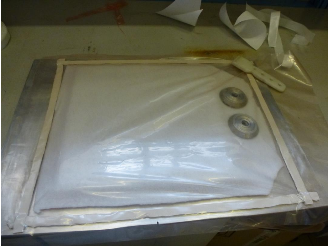
Figura 4.15: Pegado del plástico superior.
