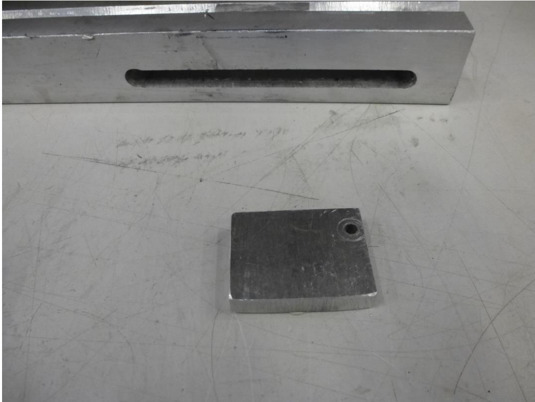
Figura 5.12: Tope de aluminio de la altura resanada al listón inferior.
