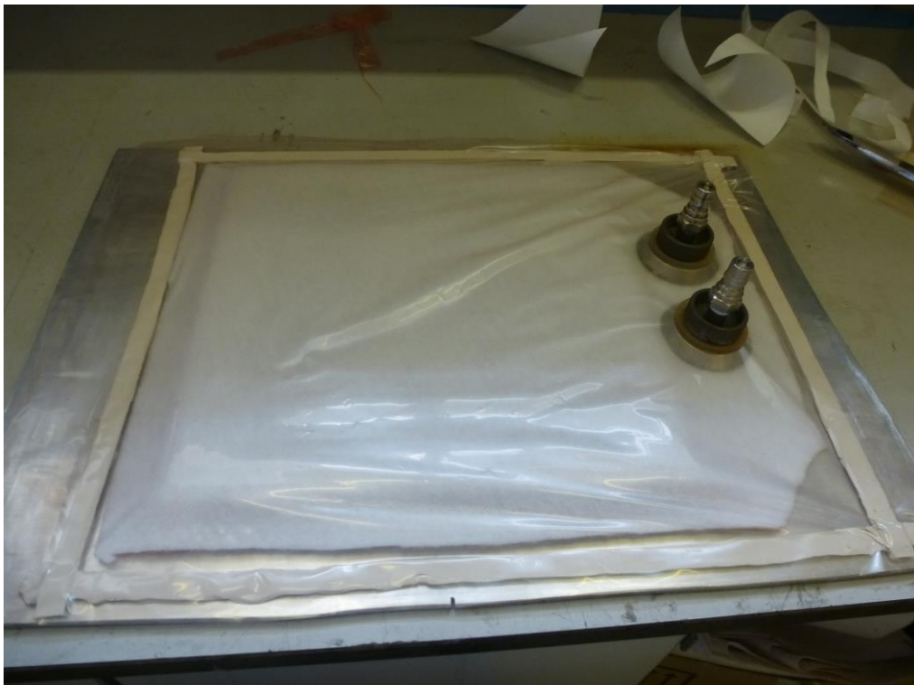
Figura 4.16: Válvulas de vacío colocadas en su posición final.
