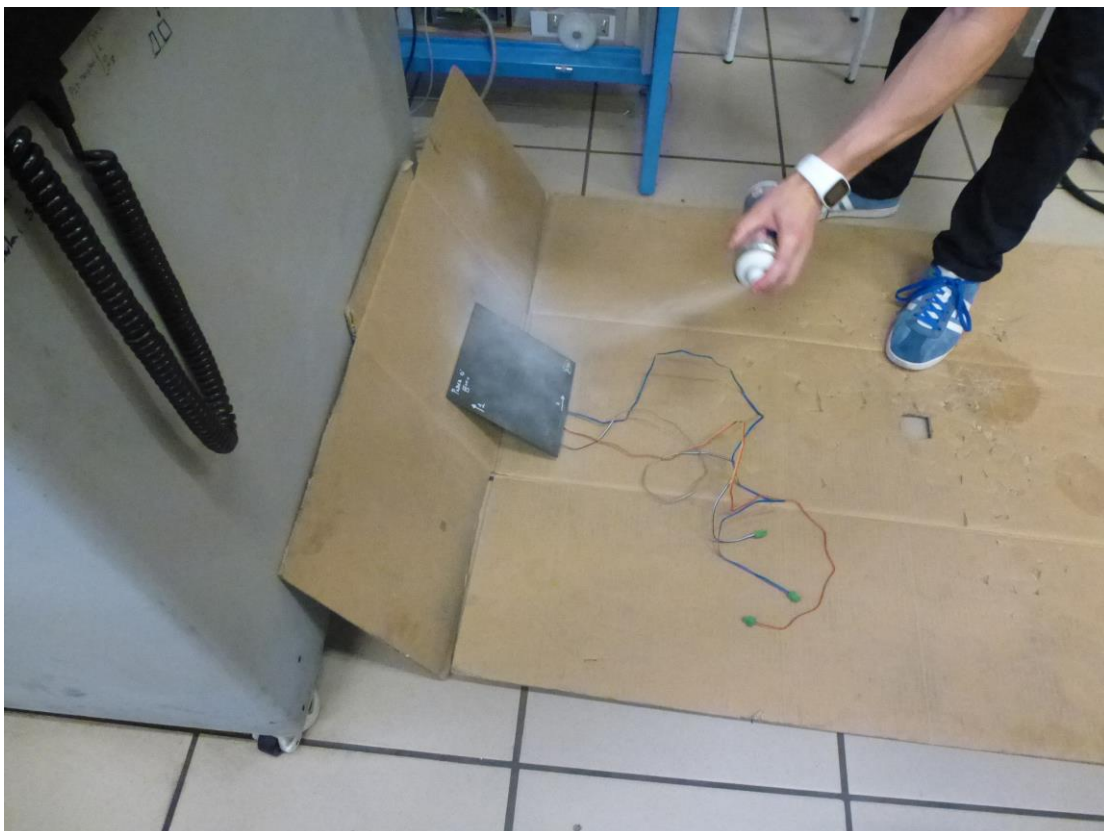
Figura 6.3: Aplicación de pintura en una de las probetas durante el marcado necesario para el sistema
