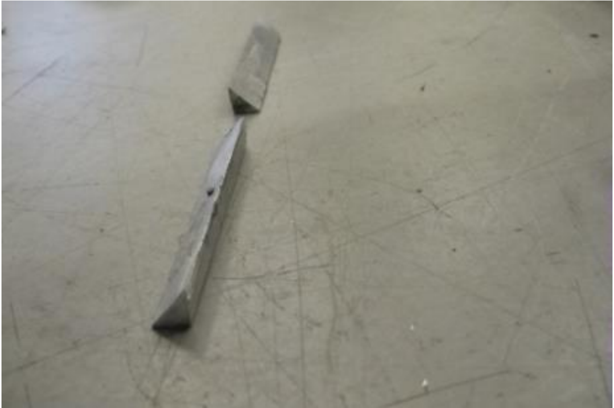
Figura 5.10: Prismas triangulares destinados a evitar esquinas reentrantes.
