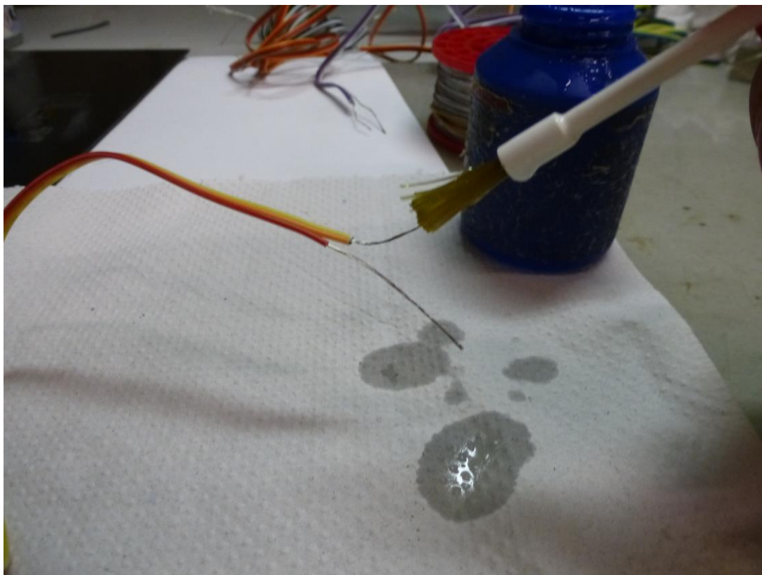
Figura 6.17: Aplicación del decapante sobre el extremo de los cables.
