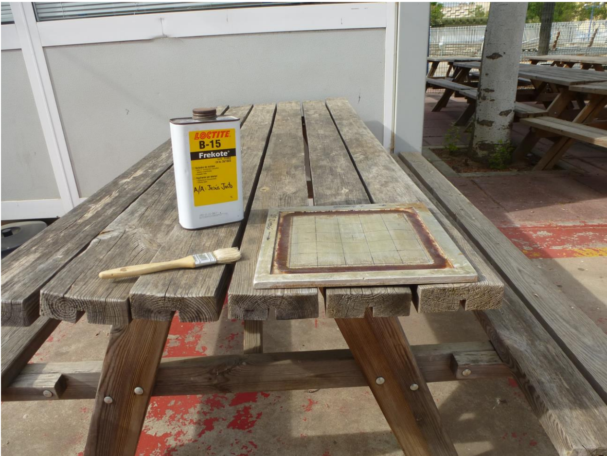
Figura 4.4: Aplicación del desmoldeante previa al apilado.
