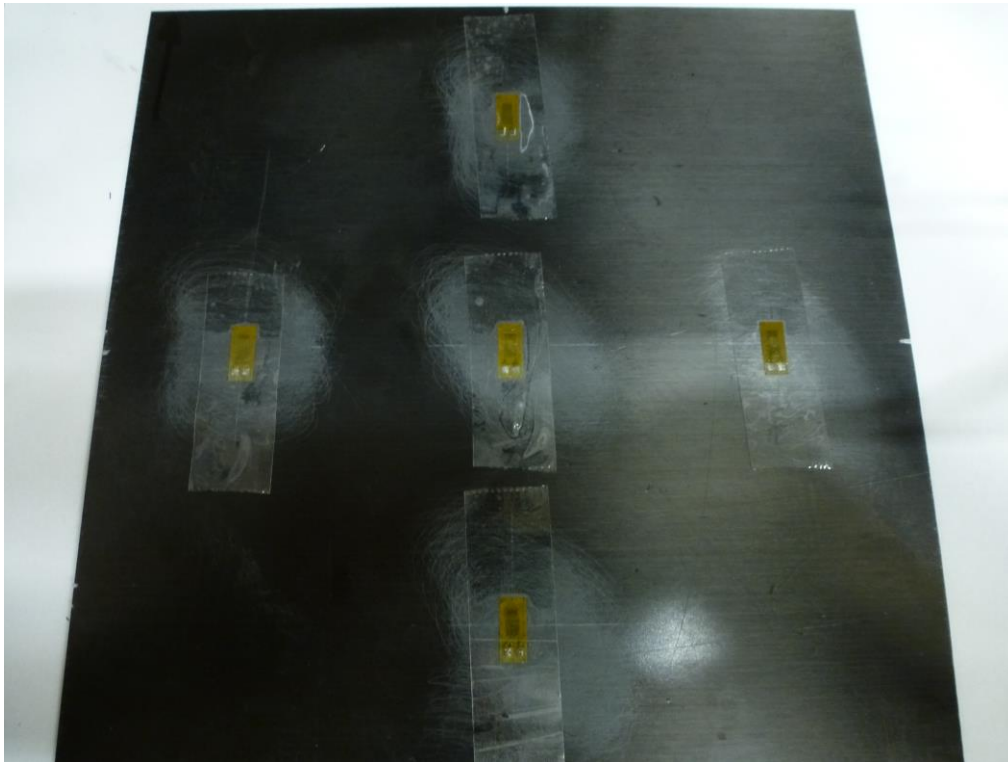
Figura 6.11: Galgas dispuestas en su posición con ayuda de la cinta adhesiva.
