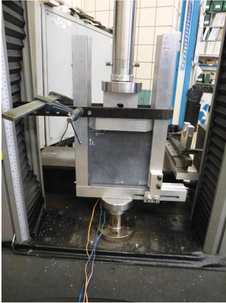
Figura 7.6: Útil con probeta situado en la posición inicial de los ensayos.
