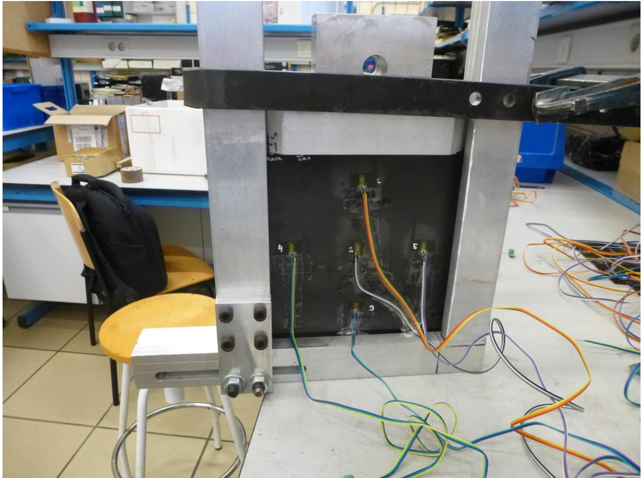
Figura 7.4: Colocación de la probeta dentro del útil de ensayo (vista trasera).
