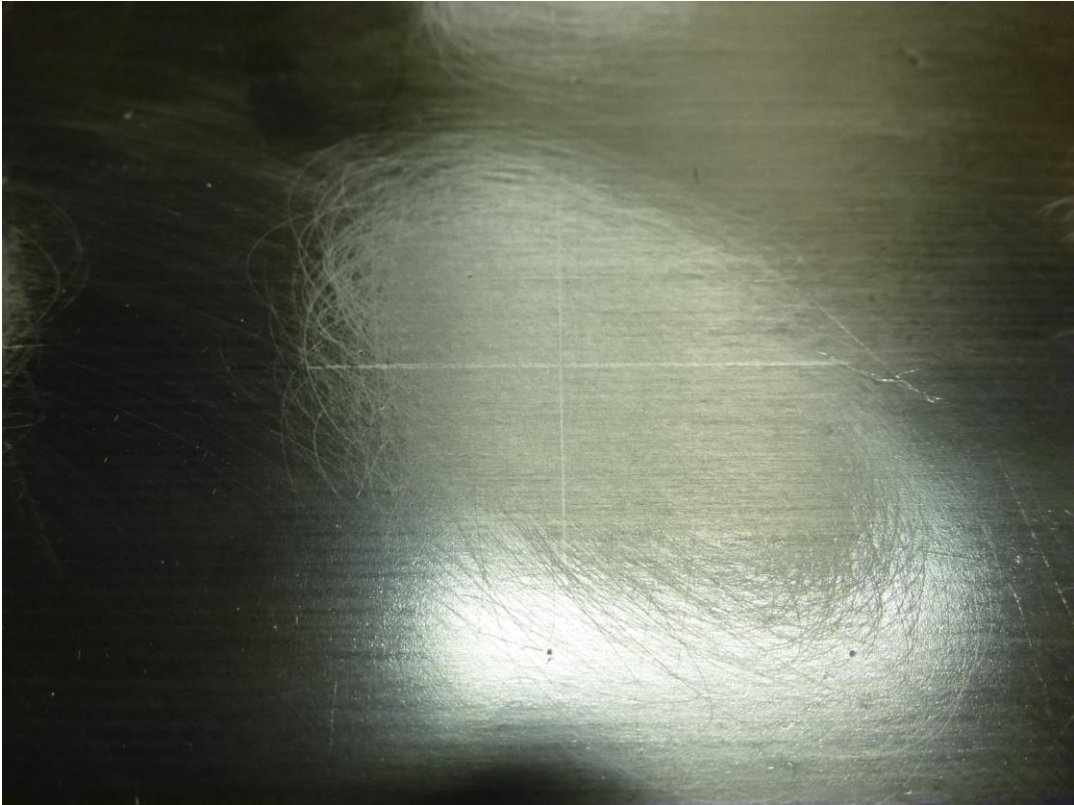
Figura 6.9: Ejemplo del marcado superficial realizado en cada uno de los puntos de instalación.
