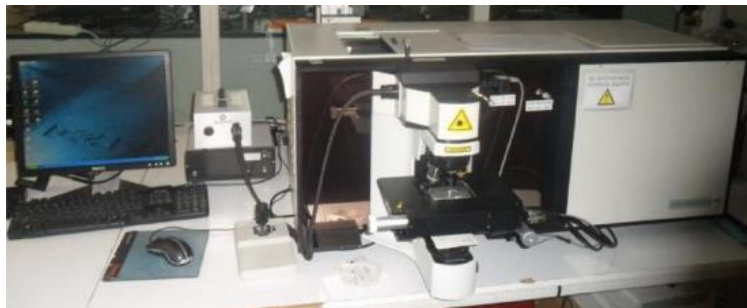
Figura 7.- Espectrómetro Raman situado en el ICMSE (CSIC-US)
