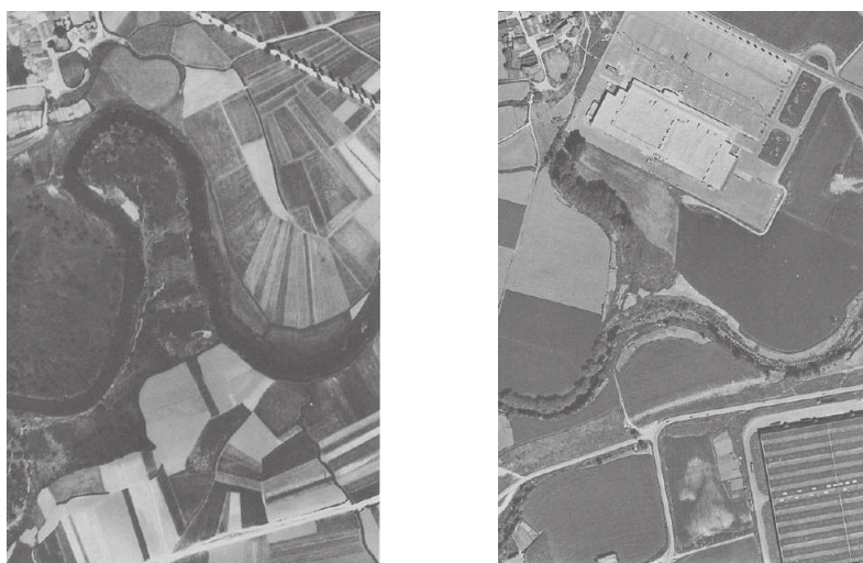
Fig. 4. Corta y relleno de un meandro del río Zadorra para realizar un centro comercial (Fuente: Manzano, J. e Izuskiza, I., 1994)
