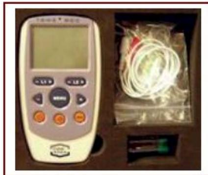
El aparato utilizado para realizar el estudio ha sido un TENS MED 931 de la casa Enraf Nonius (figura 2), el cual ha sido regulado para la aplicación de un impulso rectangular bifásico simétrico con una duración de fase de 0,3 mseg. y una frecuencia de 40Hz.
