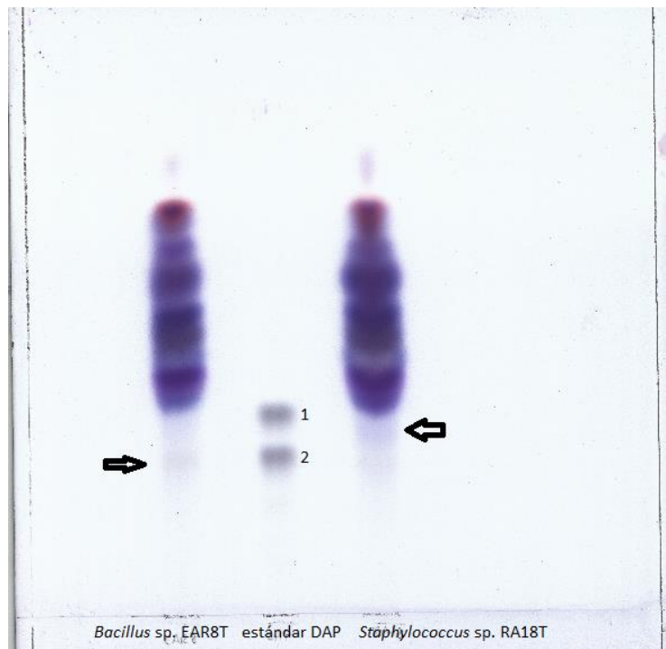
Figura 40. Placa cromatográfica revelada que muestra los datos obtenidos para del ácido diaminopimérico (DAP). La solución estándar estaba formada por los isómeros meso-diaminopimérico (marcado como 1) y LL-diaminopimérico (marcado con el 2). Las flechas señalan la banda que corresponde al isómero de cada cepa.
