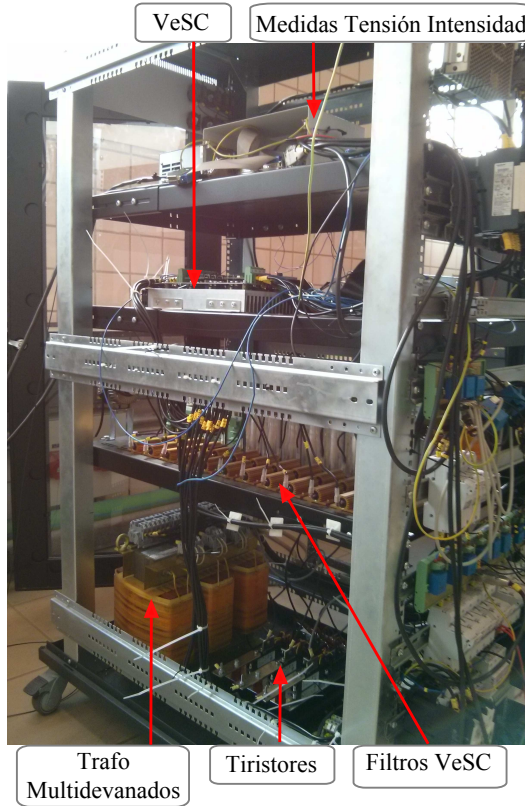
Figura 6.43: Montaje en laboratorio de la topología AC-link ShSPFC de 20 kVA.
