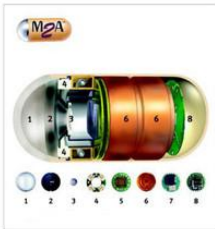
Figura 1. Primera cápsula de intestino delgado M2A (mouth to anus)
