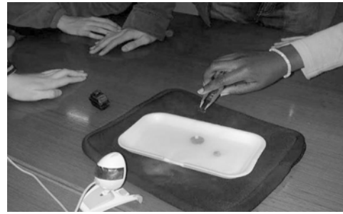
Foto 4: Observando la levitación de un imán bañado por nitrógeno líquido
