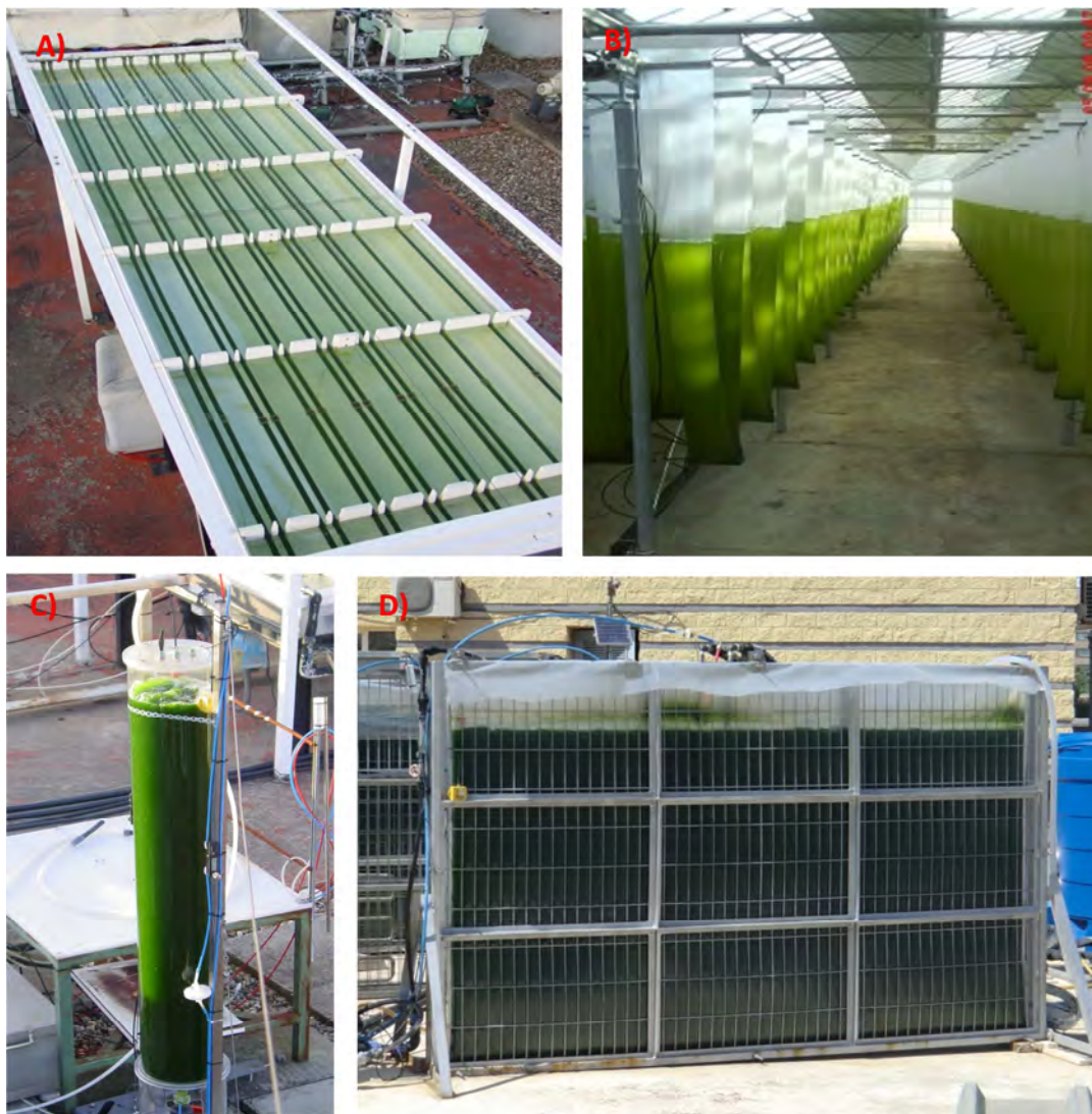
Figura 11. Diferentes diseños de fotobiorreactores cerrados: A) Tubular, C) Columna vertical. Reactor semiabierto: D) Panel vertical. Todos ellos en las instalaciones del IBVF en Isla de La Cartuja (Sevilla). B) Bolsas de polietileno ( www.empowernetwork.com )
