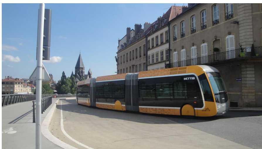
Figura 30: Mettis, Bus de Rápido Tránsito de Metz (Francia) fabricado por Van Hool, modelo Exqui.City. Este vehículo lo ha adquirido también Barcelona y Malmö en versión eléctrica-híbrida (biometano-eléctricos). Fuente: Esteban de Manuel Jerez.
