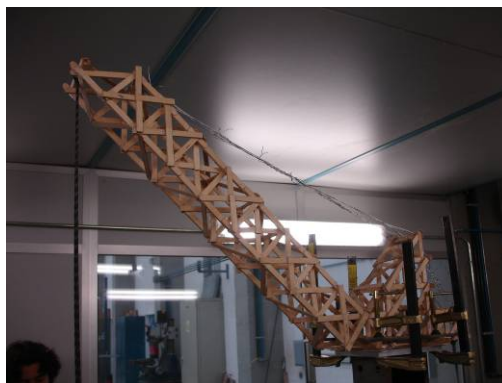
Fig. 2. Estructura de madera tipo grúa realizada por un grupo de alumnos para elevar una carga.
