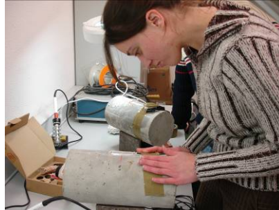
Fig.4. Pegado de banda extensométrica sobre probeta de hormigón.
