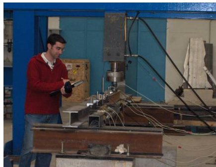
Fig.5. Ensayo de flexión de viga metálica.
