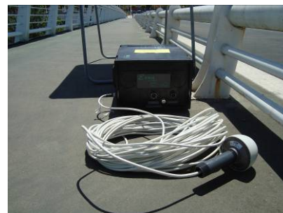
Fig. 7. Identificación dinámica de una estructura real con acelerómetros sincronizados vía GPS.
