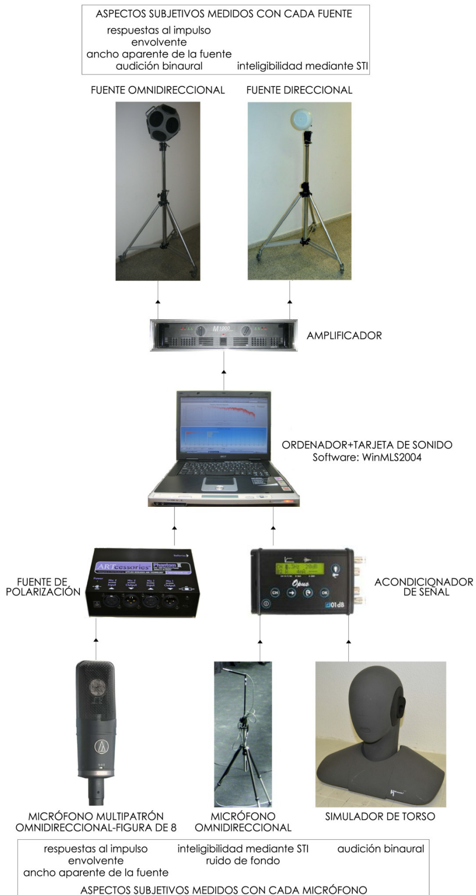
Figura 5.11. Esquema del sistema de medida.
