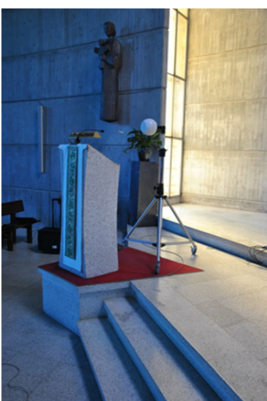
Figura 5.8. Fuente para simular el patrón de directividad de la cabeza humana.
