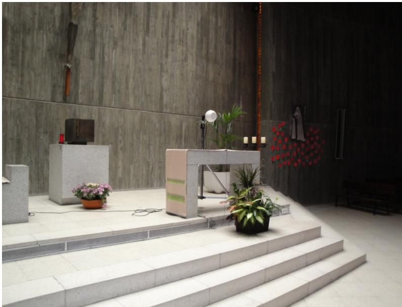
Figura 6.2.9. Fuente direccional situada en el altar (F1) durante la medición acústica in situ .
