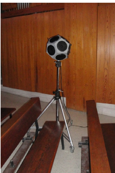
Figura 5.5. Fuente omni-direccional AVM DO12 .
