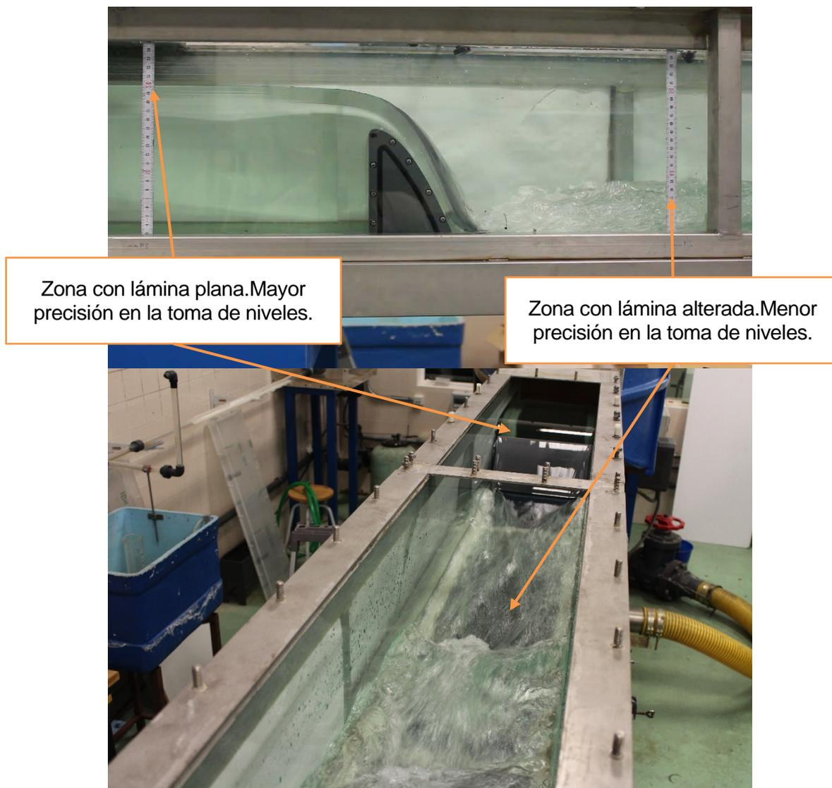
Figura 4-5. Zonas con lámina tranquila y lámina alterada por efectos turbulentos.
