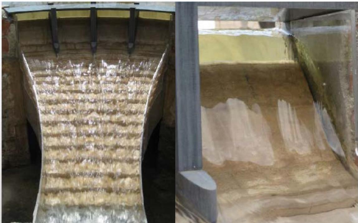
Figura 1-4. Modelo reducido de un aliviadero descargando.
