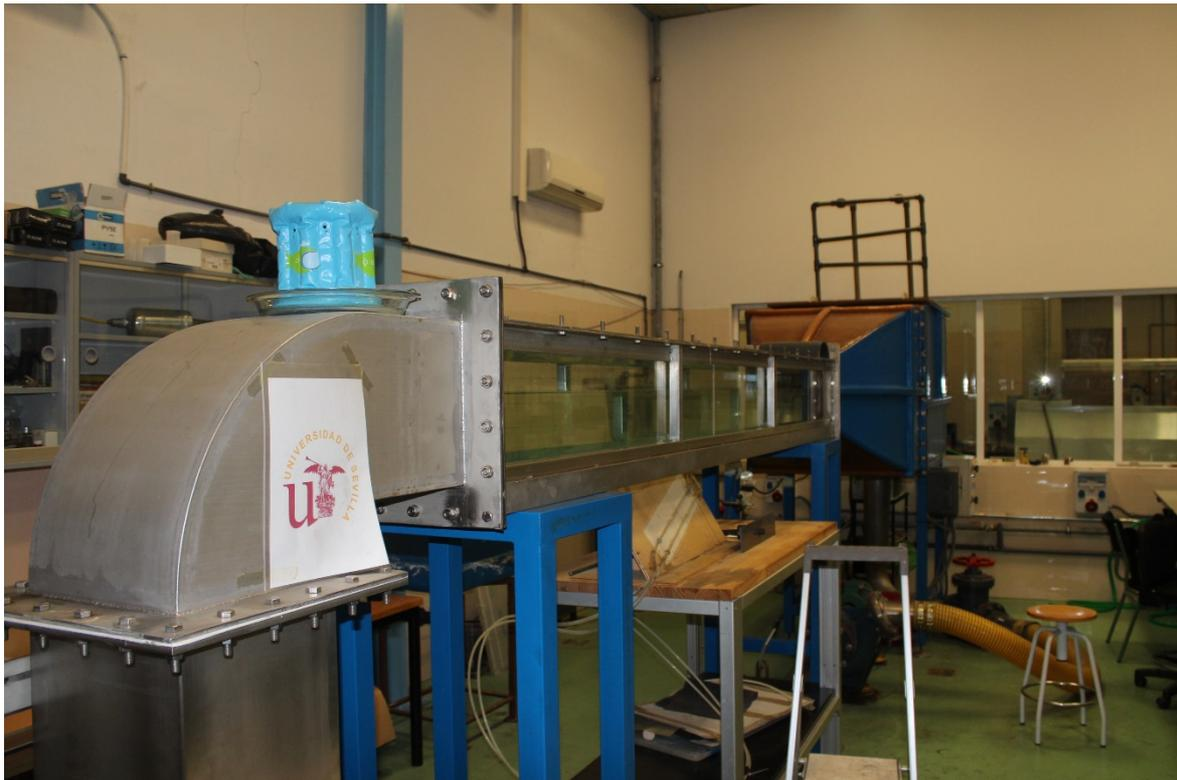
Figura 4-1. Túnel hidrodinámico del Laboratorio de Mecánica de Fluidos de la ETSI.
